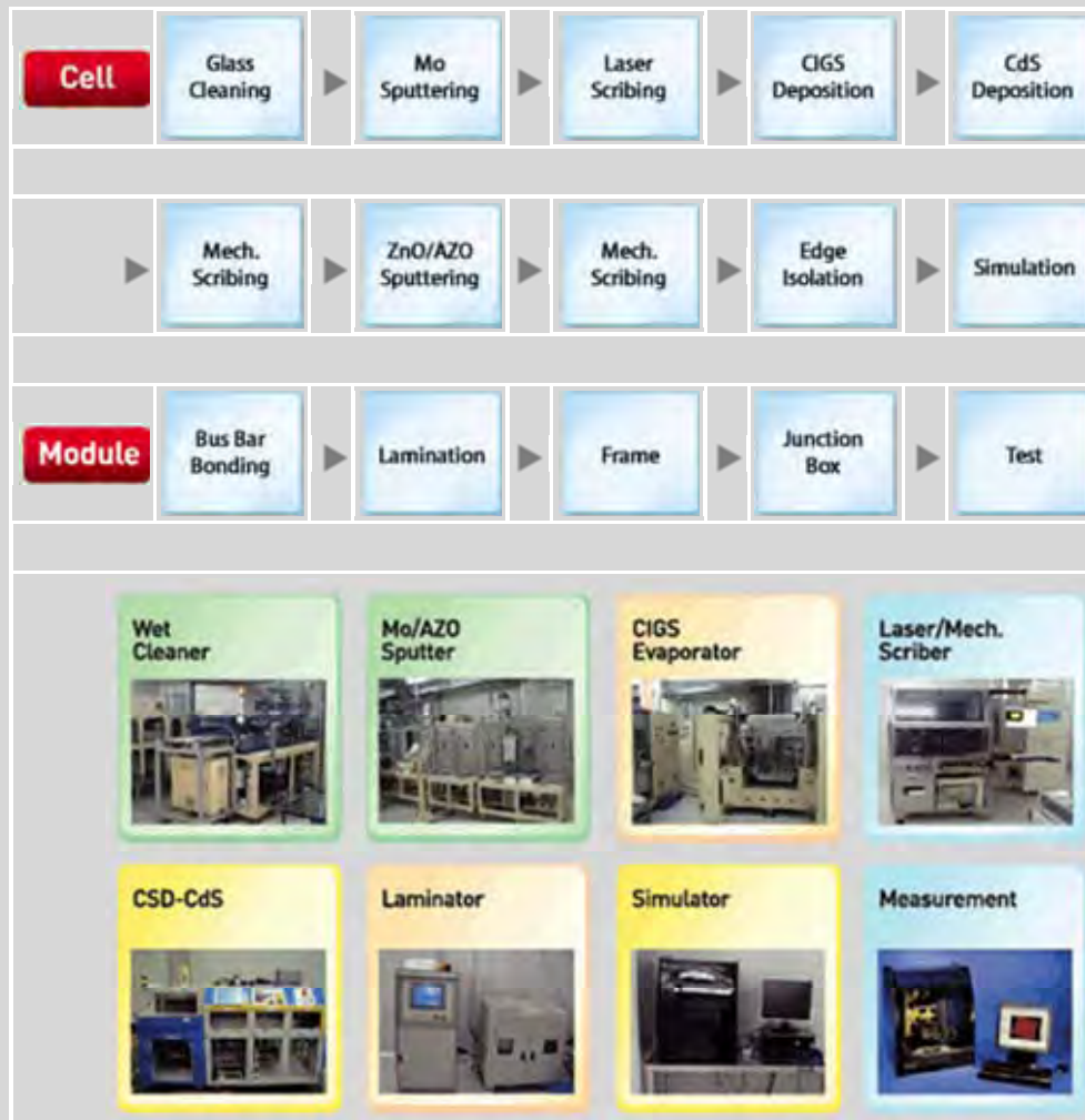
Στάδια παραγωγής φωτοβολταϊκών thin film τεχνολογίας CIGS
