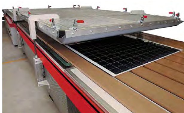
Συναρμολόγηση φωτοβολταϊκών πλαισίων (Στάδιο 3)
