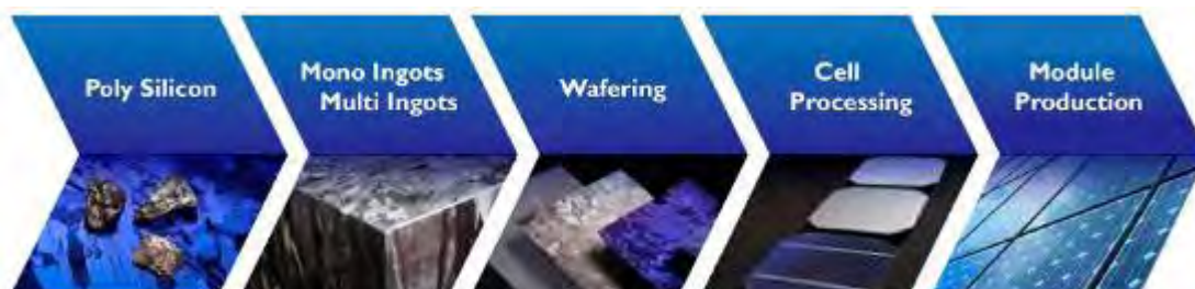
Η διαδικασία παραγωγής κρυσταλλικών φωτοβολταϊκών
